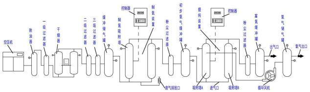
图1 高纯度变压吸附 (PSA) 制氧设备结构型式示意图
