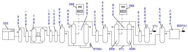
图2 高纯度变压吸附 (PSA) 制氧设备结构型式示意图(增压)
